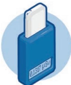
**Le dosimètre D-Shuttle**, qui a été utilisé à titre expérimental au Japon, en Biélorussie et en France, fait partie de la catégorie des dosimètres à lecture différée à photodiodes. Il a l'avantage de pouvoir être lu par l'utilisateur à l'aide d'un boîtier de lecture.
